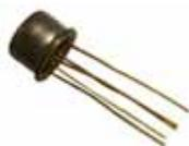
Оптроны транзисторные в металлостеклянном корпусе, состоящие из кремниевых планарно-эпитаксиальных транзисторных приемников и меза-эпитаксиальных излучателей на основе соединения GaAlAs, предназначенные для коммутации цепей постоянного тока с гальванической развязкой между входом и выходом в радиоэлектронной аппаратуре.
