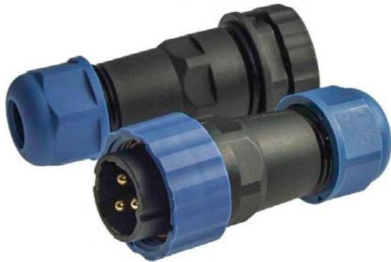
Герметичный разъем (комплект) с заглушкой SZC21 3P-F-M, вилка-розетка, 3 контакта, диаметр входящего кабеля 12 мм, IP68, 25 А, 250 В, является пылезащищенным и влагозащищенным. Герметичный разъем соответствует высокой степени защиты, что гарантирует работу разъемов при длительном погружении в воду (более 30 минут) на глубину больше 1 м.
