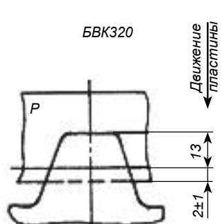
Рабочая зона воздействия управляющего элемента (положение переключающей пластины в момент срабатывания).
